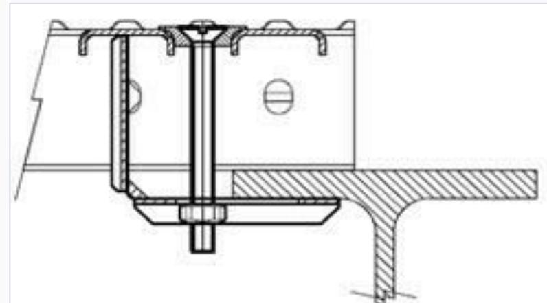
Attache de fixation prémontée permettant la fixation de profil à leur support.
