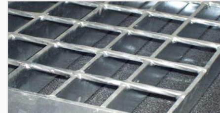
Le [caillebotis Electroforgés](#) est constitué de plats porteurs et d'entretoises électro-soudés à chaque intersection de maille. Ainsi, le caillebotis peut-être recoupé sur chantier pour ajuster les dimensions ou pour créer une ouverture, sans risque que le caillebotis se désassemble spontanément.
